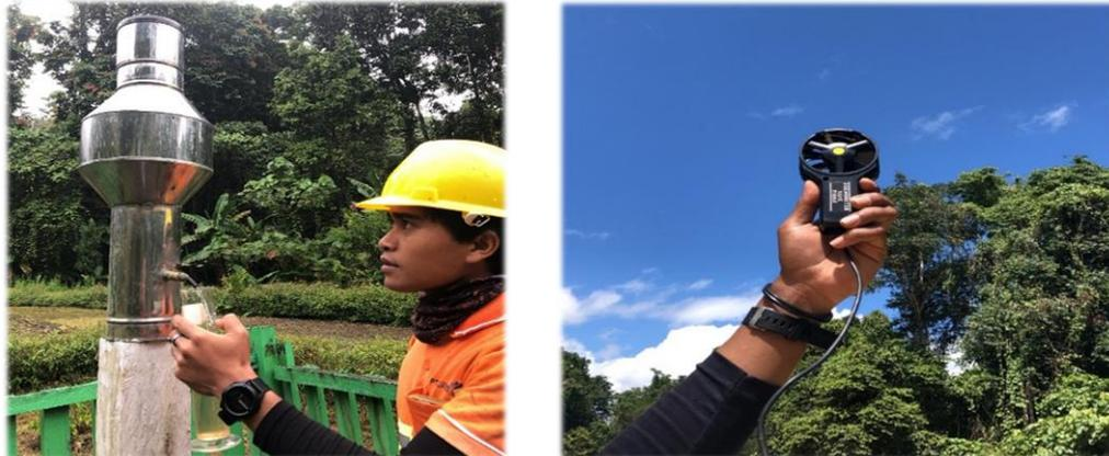
Gambar 7. Pengukuran curah hujan dan kecepatan angin
